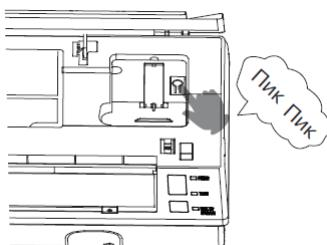
Для выключения кондиционера нажмите на кнопку **EMERGENCY SWITCH**. При этом Вы услышите одиночный звуковой сигнал, подтверждающий выключение кондиционера. Для отключения данных режимов нажмите кнопку **ON/OFF** на пульте дистанционного управления, кондиционер перейдет в режим работы, ранее заданный на пульте ДУ.
